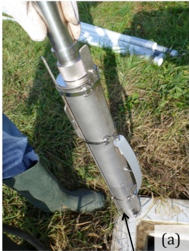
a) Sismometro da pozzo Guralp SP1 ( T = 10 s)
