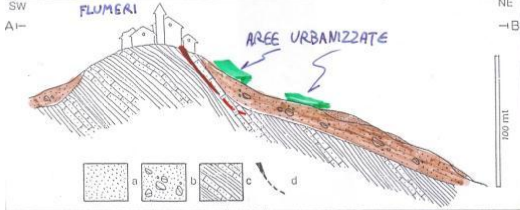
Fig. 10 - Sezione geologica dell'area di studio (la traccia è riportata in fig. 9a). a = detriti di frana recenti, prevalentemente argillosi; b = detriti di frana antichi, inglobanti pezzame litico eterogeneo ed eterometrico; c = substrato argilloso-arenaceo dell'Unità di Villamaina; d = lesione rilevata dopo il terremoto del 23/11/80, connessa ad una probabile riattivazione di superfici di scorrimento antiche.
